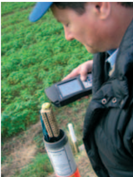
Standort-Identifizierung von KKS Messpfählen über die einmalige ID-Nr. des RFID-Transponder
