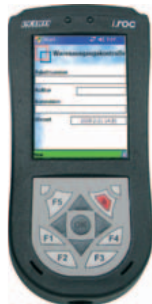
Industrie PDA i.roc 41* im Einsatz als Betriebsdaten-Erfassungsterminal (BDE)
